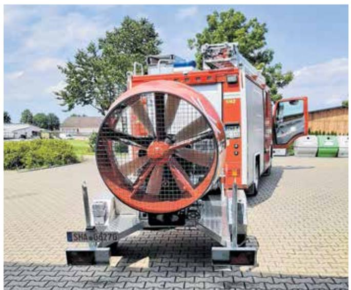
Das Gerät verfügt über eine Wassernebeleinrichtung, die das fein zerstäubte Wasser bis zu 60 Meter weit werfen kann.
