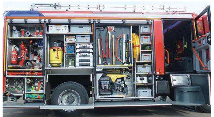
Rechte Seite mit Stromerzeuger, Hebekissen, Einbauschrank und Wassersauger.
