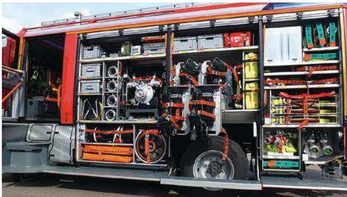
Linke Seite mit Sprungpolster, Faltbehälter, Überdrucklüfter, Tragkraftspritze und Pressluftatmer.
