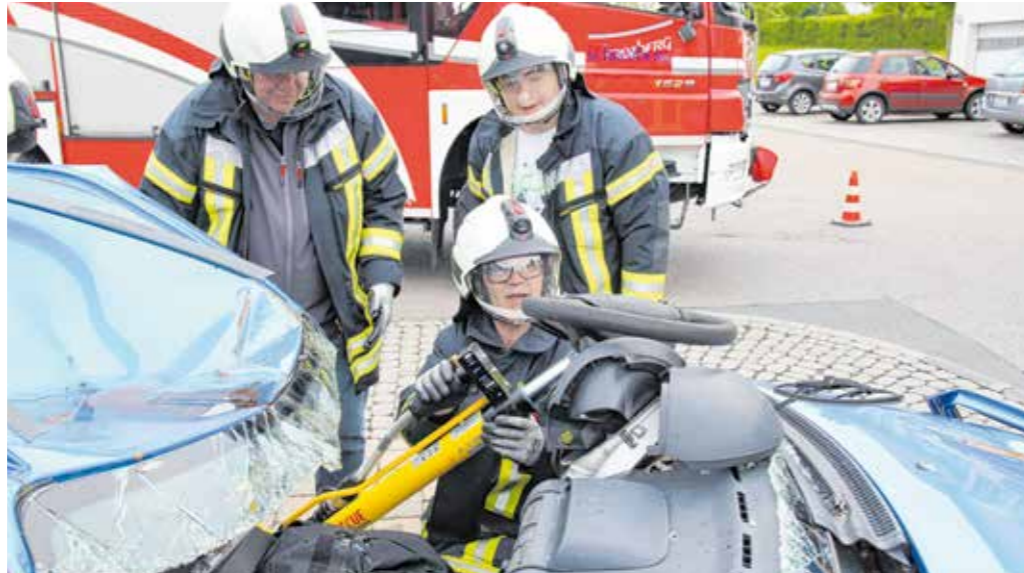
Den Besuchern des Infoabends wurde gezeigt, wie hydraulische Rettungszylinder bei verunglückten Autos eingesetzt werden. Foto: privat
